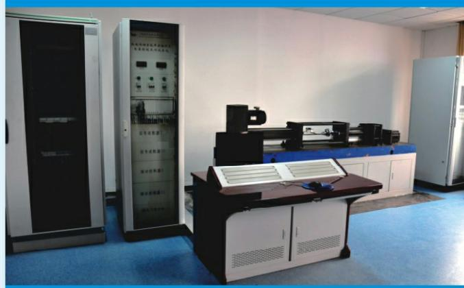
机电作动系统半实物仿真系统: 机电作动系统半实物仿真系统采用机电作动系统作为加载装置，可以进行机电作动系统、电静液作动系统等的推力、作动行程、作动速度、传动效率等多种指标的测试，最大可提供加载推力为10吨。
