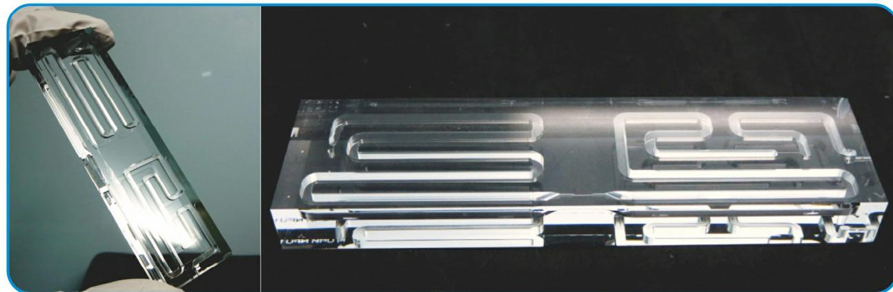
用于流式细胞仪的硬质基底无鞘流聚焦微流控芯片
