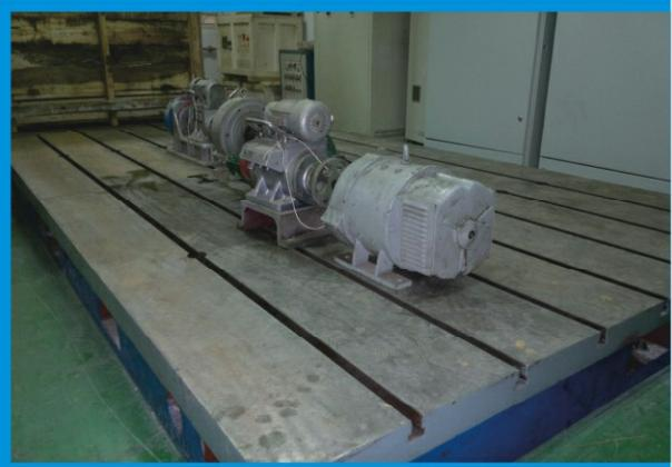
大型传动实验平台: 大型传动实验平台主体为4m×7m传动基础实验平台，可搭载各种传动设备如110kW电机、250kW电涡流加载器、大功率分扭传动实验箱、其他各种实验设备等等。为学科的科研工作奠定了平台基础。
